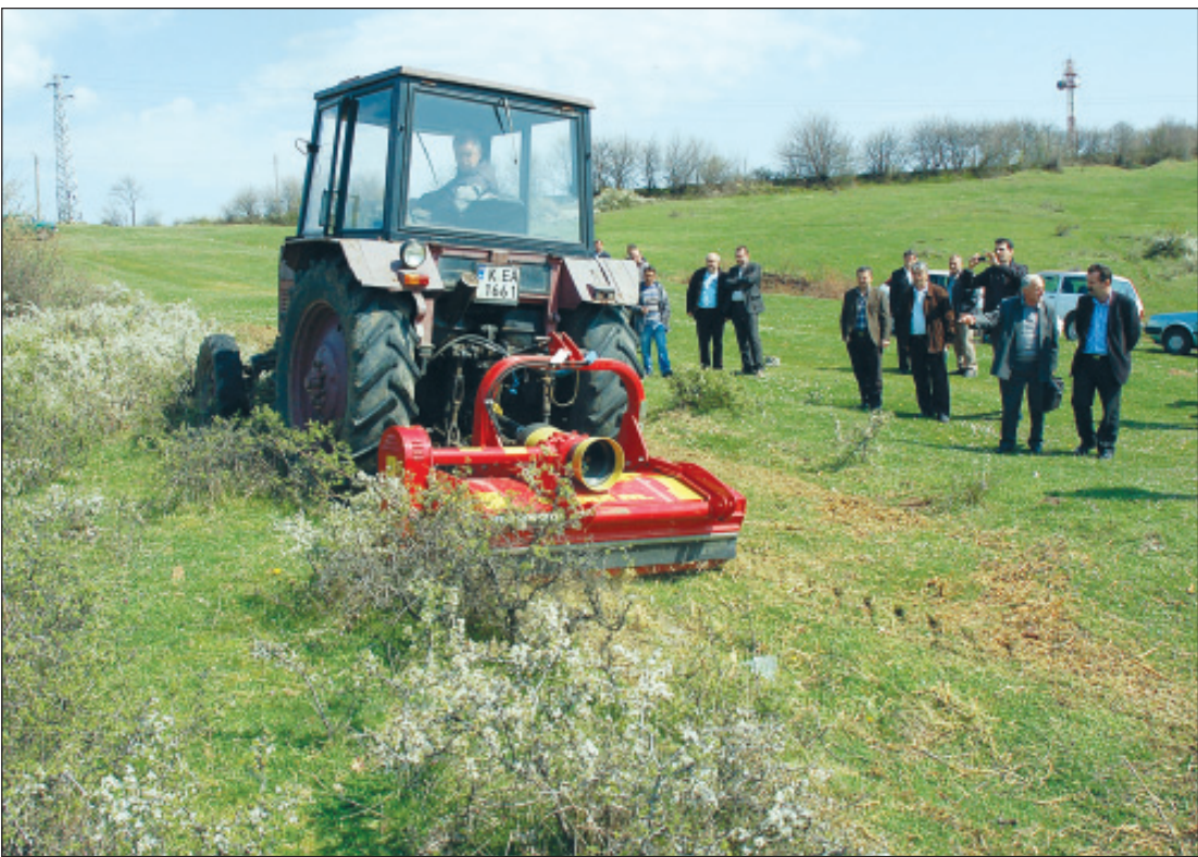
Фермери и земеделци от Кърджали и областта се събраха край село Чилик, недалеч от областния град, да видят как нова машина разчиства пасищата от храсти, трънки, шипки, глози и къпини. Машината разгребва стебла и клони с дебелина до 7 сантиметра
